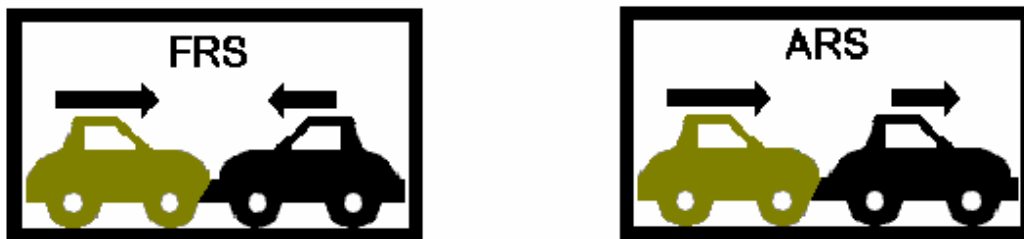
Abb. 174: Schema der beiden Arten des elastischen Stoßes, bei dem jeweils ein ruhender Körper übrigbleibt. Beim frontalen Ruhestoß (FRS) kommt der Körper mit der größeren Masse (dunkel gezeichnet) zur Ruhe, beim Auffahrts-Ruhestoß (ARS) bleibt der Körper mit der kleineren Masse nach dem Stoß schlagartig stehen.
