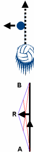
Abb. 22: Ein großer Ball berührt nichtzentral eine kleine Kugel so, dass nur die Andeutung einer senkrechten Auslenkung ohne Energieübertrag registriert werden kann. Das untere Bild zeigt das reale Bild.
